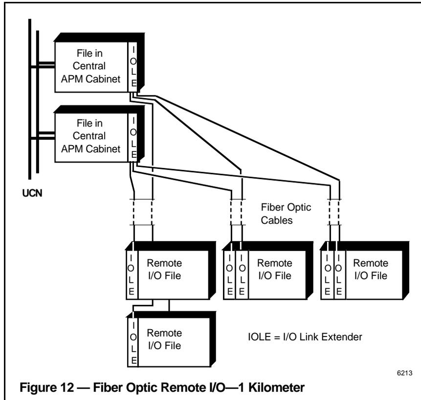
Figure 12 — Fiber Optic Remote I/O—1 Kilometer
